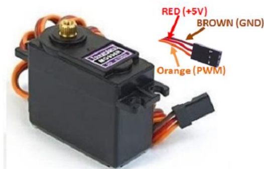
Gambar 6. Bentuk Fisik Motor Servo [8]
