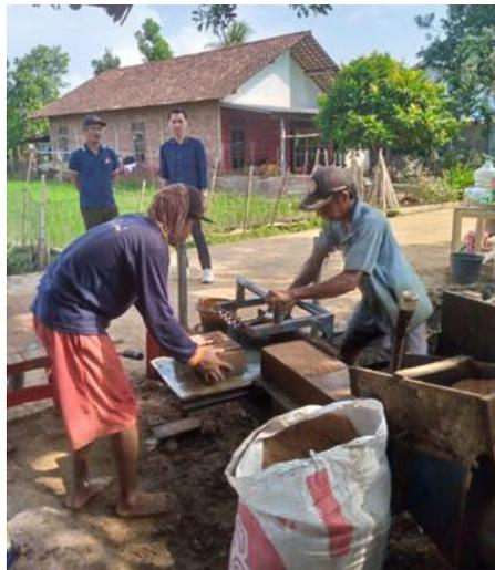
*Gambar 5.* Proses pencetakan batu bata dengan mesin
