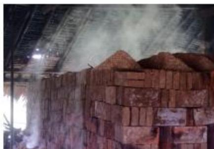
*Gambar 4. Proses Pemangangan Batu Bata*
