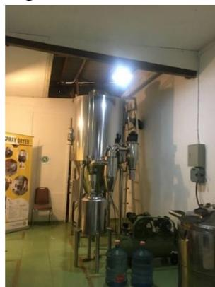
Gambar 3. Alat *spray dryer* yang berada di Laboratorium Pusat Riset Bioteknologi Molekular dan Bioinformatika UNPAD
