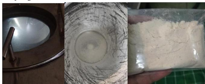
Gambar 4. Nozzle Alat Spray Dryer Ketika Pengeringan dan Hasil Pengeringan Sampel
