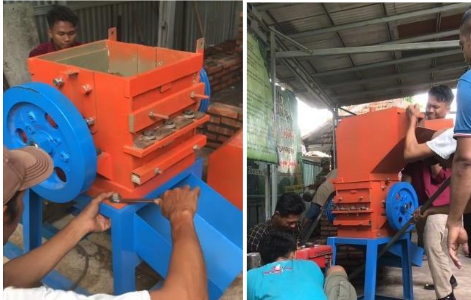
Gambar 3. Pemasangan dan Sosialisasi Mesin Pencacah Sampah
