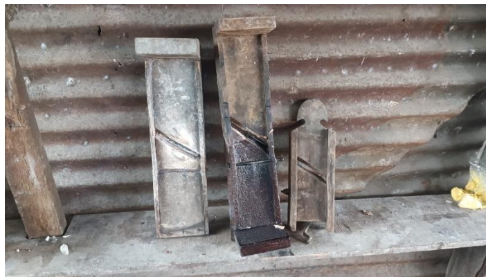
Gambar 1. Alat pengiris pisang tradisional yang terbuat dari kayu
