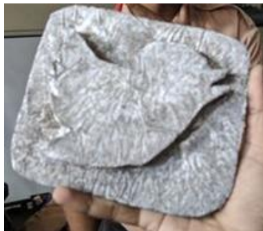
Gambar 1. Coran berbentuk ornamen hasil praktek pengecoran di SMK Tempat Pengabdian.
