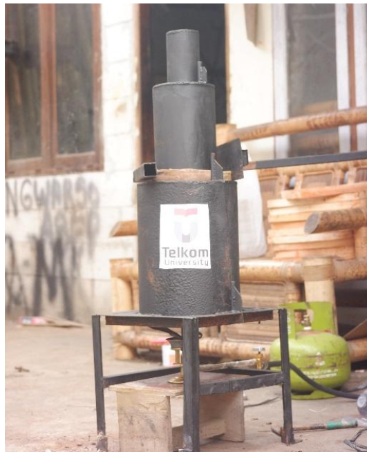
Gambar 7. Alat bending rotan dan bambu hasil tim pengabdian masyarakat
