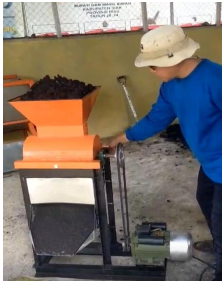
Gambar 3. Mesin hammer mill sedang menghaluskan limbah decanter solid kering
