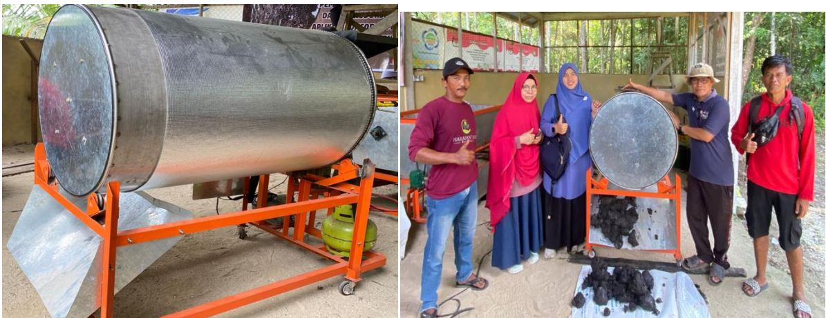
Gambar 2 . Penyerahan mesin rotary dryer untuk pengeringan limbah decanter solid sebagai bahan baku kompos
