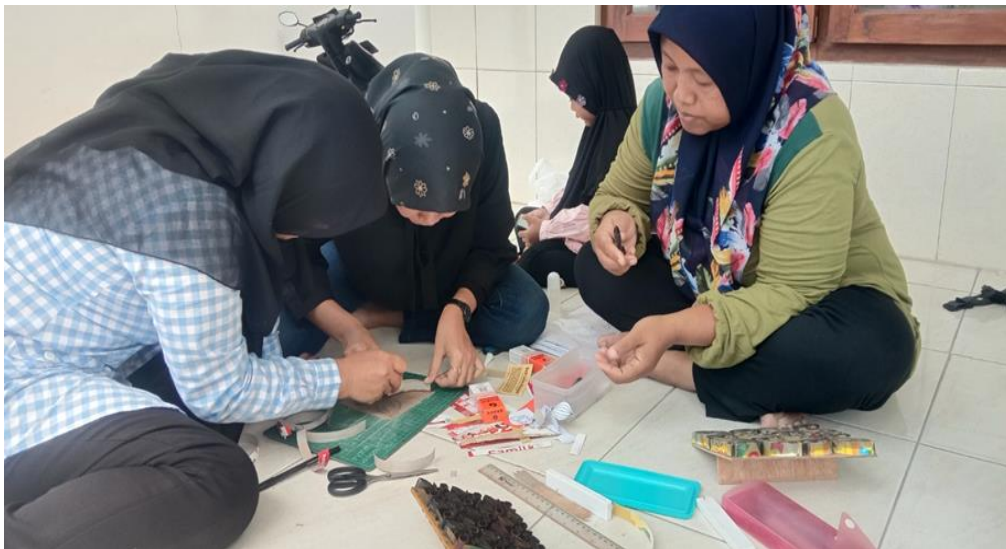
Gambar 2: Praktek dalam Membuat Canting Cap Menggunakan Limbah Kardus
