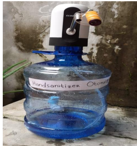
Gambar 6. Handsanitizer Otomatis dengan Sensor Infrared
